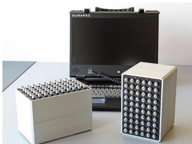
**Bild 2.** Aktive Komponenten des Prüfsystems FLEXUS 120: Ultraschallgerät sowie Ultraschall-Sende- und Empfangsarray mit jeweils 10 x 6 Prüfköpfen
