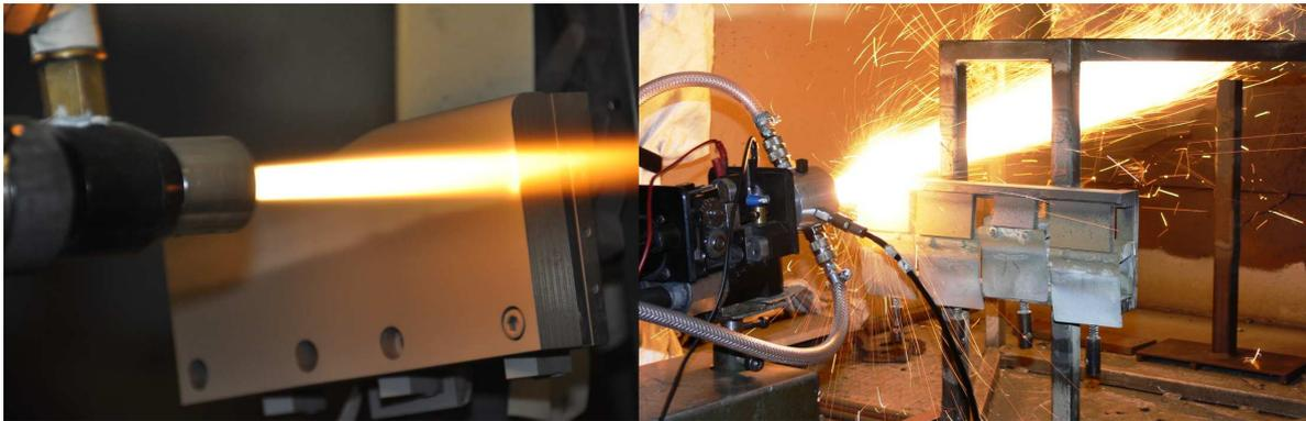
**Abb. 1.** Hochgeschwindigkeitsflammspritzen (links) und Lichtbogenspritzen (rechts).
