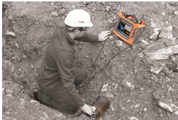
Abb. 6. Robuster Einsatz. Das komplett abgeschirmte Gehäuse (IP54 für rauen Außeneinsatz)
