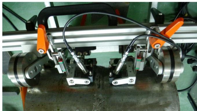
Abb. 13. Schweißnaht-Scanner. Schweißnähte können mit einem solchen Scanner mit Magnet-Rädern komfortabel abgefahren werden. In diesem Beispiel sind zwei Gruppenstrahler-Prüfköpfe und zwei TOFD-Prüfköpfe im Einsatz.
