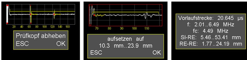
Abb. 17. Prüfkopf-Justierung. Beliebige Einschwinger-Prüfköpfe können an das Gerät angeschlossen und vermessen werden. Klartext-Anweisungen helfen hierbei dem Bediener. Die Prüffrequenz und die Messbereiche (für die Modi SI-RE = Sendepuls-Rückwandecho bzw. RE-RE = Rückwandecho-Rückwandecho) werden bestimmt und ausgegeben.
