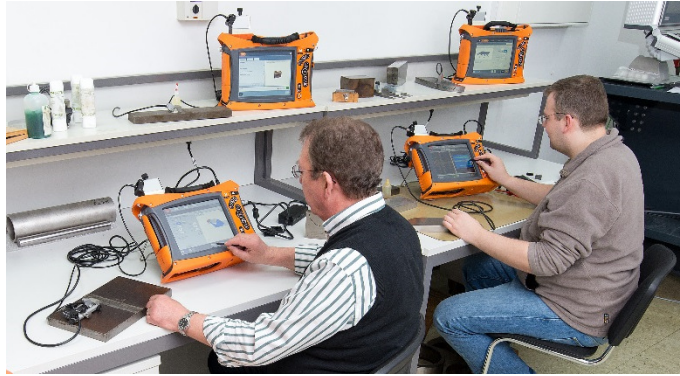
Abb. 14. Anwendungstechnisches Labor. Seit Anfang 2014 stehen ausreichend Demogeräte im Prüflabor der Firma KARL DEUTSCH zur Verfügung. Geschultes Personal erstellt mit Hilfe der CIVA-Software die Prüfcodes auch für komplexe Prüfaufgaben.
