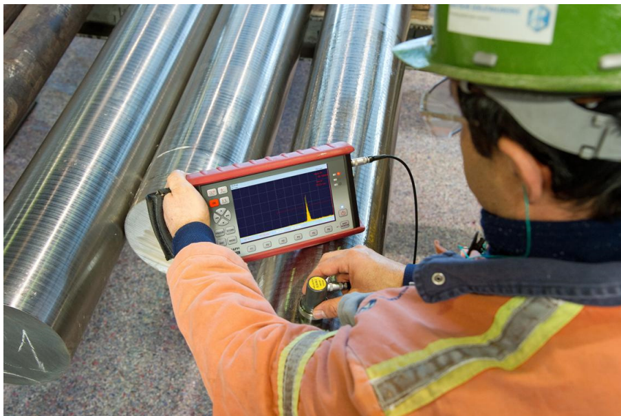
Abb. 2. Echograph 1095. Ein Prototyp des neuen Prüfgerätes im Einsatz zur Stabstahlprüfung bei den Deutschen Edelstahlwerken (DEW) in Witten.
