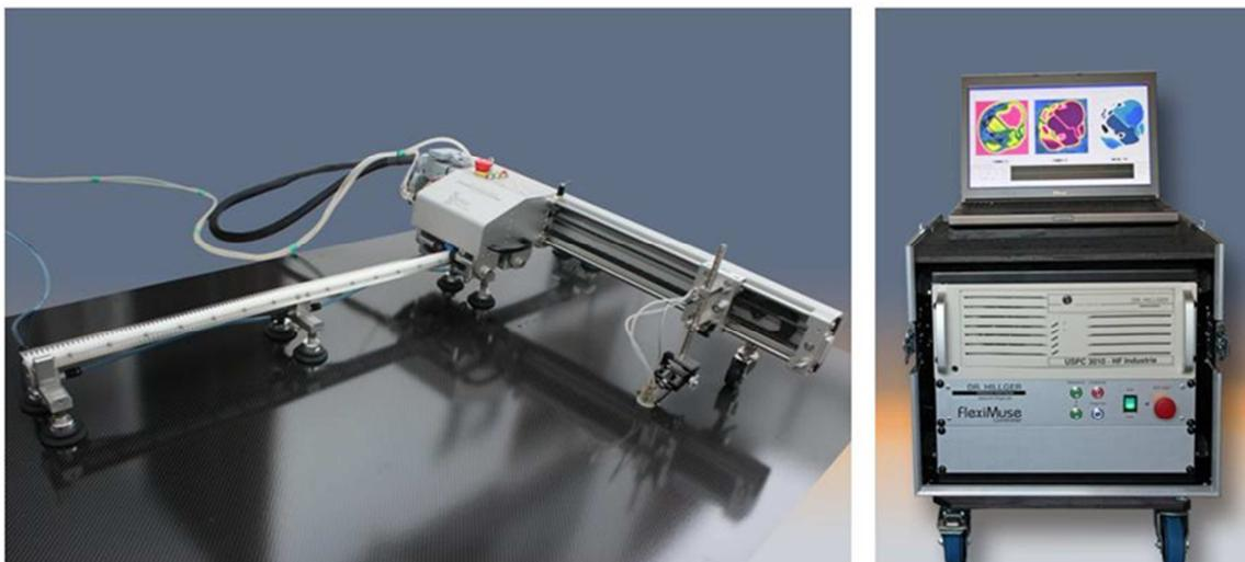
**Abb. 4.** FlexiMuse bestehend aus Manipulator und mobilem 19"Rack
