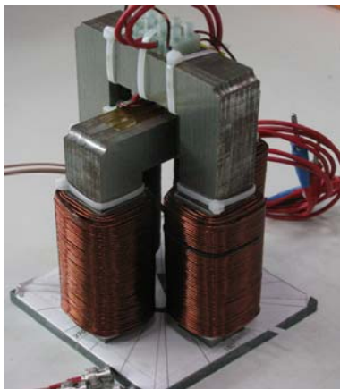
Abbildung 4. Labormuster-Prüfkopf (links) und Amplitudenverteilung für verschiedene Polarisationsrichtungen des Referenzempfängerwandlers (rechts) und eingestellte Magnetisierungsrichtungen
