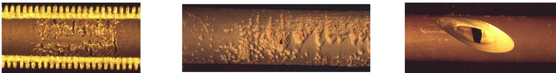
Abb. 5: verschiedene Schädigungsarten (Innenkorrosion, Dampferosion, Erosion)
