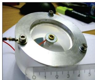
190 nm Indiumzinnoxid (ITO) auf sphärisch gekrümmten Quarzglas-substrat, mit einem konstanten Fokusabstand von 55 mm.
