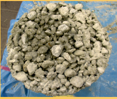
Kiesnest mit Luftporen
