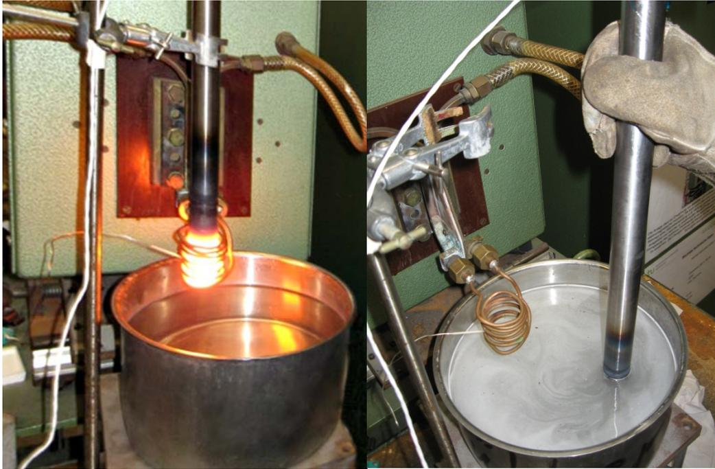
Abb. 3. Induktive Erwärmung und anschließende Abschreckung
