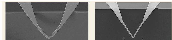
Cantilever nach Fertigung und vor der Bearbeitung mit Ionenfeinstrahlen (Focused Ion Beam = FIB).
