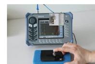
Impuls-Echo-Messung an Prüfboden mit 5 MHz Einzelschwinger-Prüfkopf
