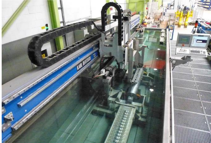
**Abb. 1.** Gesamtansicht der Tauchtank-Prüfanlage für Luftfahrt-Anwendungen bei der VDM Metals GmbH in Unna.
