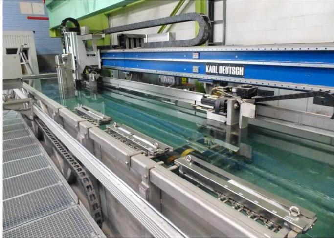
**Abb. 5.** Die Prüfanlage verfügt über vier Prüfkopfhalter mit Senkrecht-Prüfköpfen, die über eine Schnellwechsel-Vorrichtung getauscht werden können. Im Bild sind vorne rechts die drei Prüfkopfhalter zu sehen, die gerade nicht in Verwendung sind.
