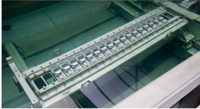
**Abb. 7.** In der Null-Position des Prüftanks werden diese Testkörper-Halterungen alle zwei Stunden überfahren, um die Stabilität der Prüfempfindlichkeit zu verifizieren.
