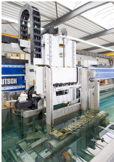
**Abb. 2.** Prüfkopfhalterungen oberhalb eines runden Testköpers mit einer Länge von ca 1,5 m. Bei solch kurzen Bauteillängen sind nur zwei der drei verfügbaren Drehrollenstationen im Einsatz. Durch gummierte Auflagerollen werden Beschädigungen der Bauteiloberflächen vermieden.
