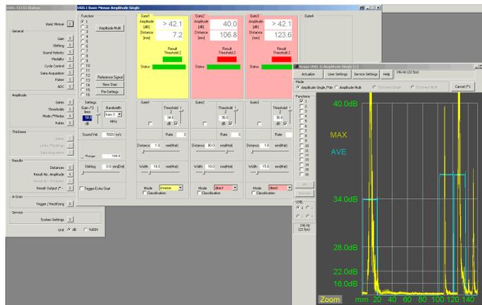
**Abb. 8.** Prüfergebnis als A-Bild einer Flachboden-Bohrung mit 0,8 mm mit sehr gutem Signal-Rausch-Abstand (Stangen-Durchmesser 203 mm, Fehlertiefe 97 mm). Am linken Rand des A-Bilds sieht man das Eintrittsecho, welches mit einer (blauen) Blende ständig überwacht wird. Zur Einbringung der 0,8-mm-Reflektoren wird mit größerem Durchmesser vorgebohrt. Diese große Bohrung erscheint am rechten Rand des A-Bilds mit einer Amplitude deutlich über 100% Bildschirmhöhe (dritte blaue Blende).
