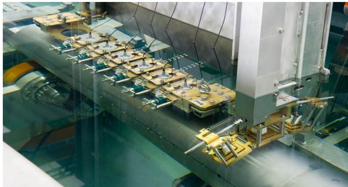
**Abb. 6.** Ein weiterer Prüfkopfhalter (rechts im Bild) enthält die beiden Winkel-Prüfköpfe zur Detektion oberflächen-naher Fehlstellen und einen Senkrecht-Prüfkopf zur ständigen Überwachung des Rückwandechos.
