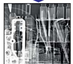
Belichtungszeit: 5 min, Röntgenenergie: 7.5 MeV, SDD: 3.5 m, SNR: 500
