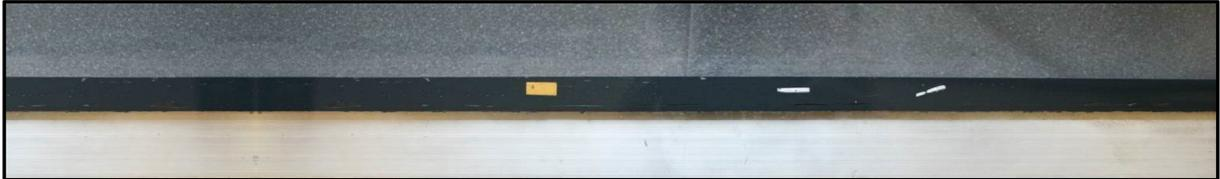
**Abbildung 7:** Foto mit Teilansicht der Glaskleberbindung mit künstlichen Fehlstellen zwischen Glas und Kleber
