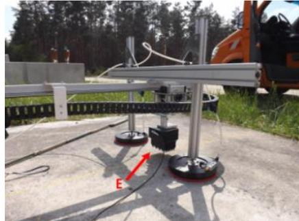
Abbildung 7: Scanner auf der Fundamentplatte RuFUS mit dem Empfängerprüfkopfarrays (E)
