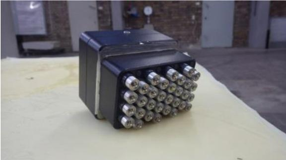
Abbildung 6: Prüfkopfarray mit 32 Einzelprüfköpfen
