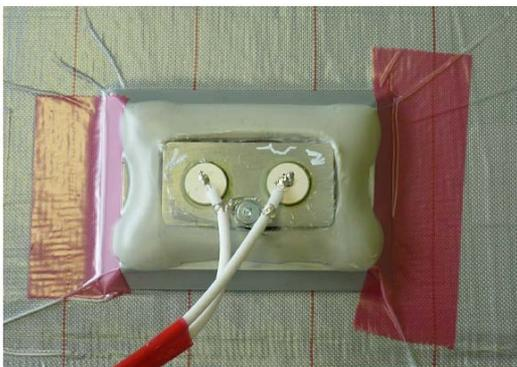
(a) Erprobungsversuch an Prototypen des Laminatdickensensors
