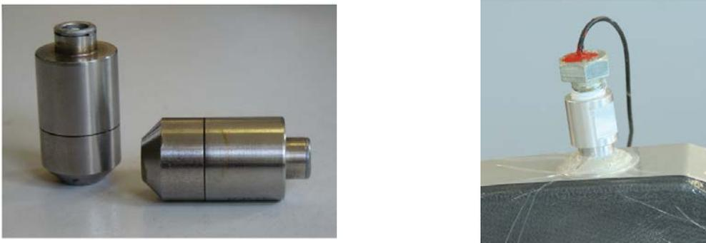
Abb. 4.1. Konventionelle Prüfköpfe zur Aushärtungsüberwachung mit Ultraschall
