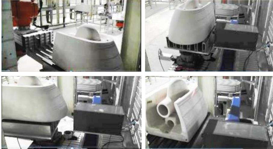
**Abb. 15.** Links oben: Bauteilzufuhr mit Roboter. Rechts oben: Prüfung der ersten Längsseite. Links unten: Prüfung des Radiusbereichs. Rechts unten: Prüfung der gegenüberliegenden Längsseite. Heizsystem und Infrarotkamera befinden sich in der grauen Box.
