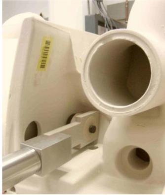
**Abb. 1.** Miniaturisierter Mikrowellensensor bei der Feuchteprüfung am WC.
