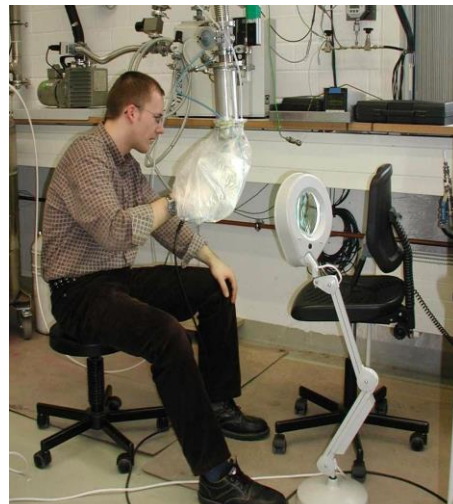
Abb. 4 Ortung einer Leckage in einem Interlayer-Joint
