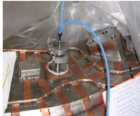
Abb. 8 Spülung einer W7-X Spule mit heliumfreiem Gas
