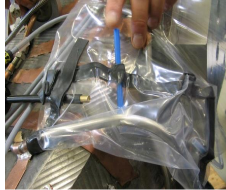
Abb. 5 Nachweis der Dichtheit einer LHe-Leitung
