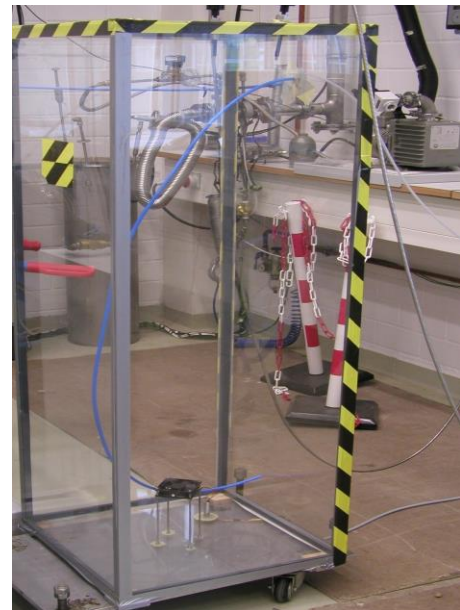
Abb. 6 Ortung einer Leckage in einer Testkammer
