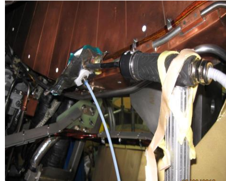
Abb. 9 Nachweis der Dichtheit einer LHe-Leitung
