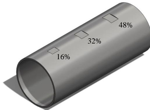
**Abbildung 4:** Rohrförmiger Testkörper mit Wanddickenreduktionen von 16%, 32% und 48%
